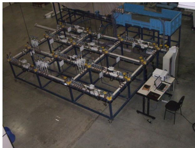
FOTOGRAFIA 1: LENHS - BANCADA DE SIMULAÇÃO DE UM SISTEMA DE ABASTECIMENTO DE ÁGUA TÍPICO
